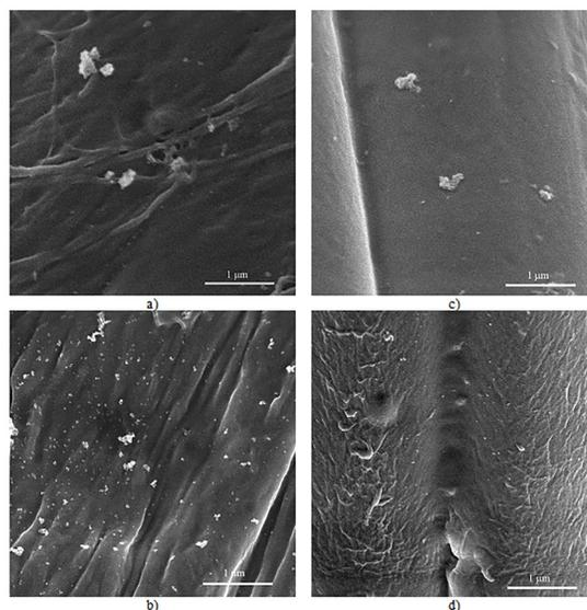
Figure 3: FESEM images of (a) CO+BTCA4+Cu, (b) CO+BTCA6+Cu, (c) CV+BTCA4+Cu and (d) CV+BTCA6+Cu fibers
